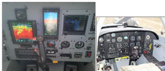
Izquierda: Layout de la nueva aviónica para la modernización del avión Pillán, en reemplazo de la anterior (derecha), presentada en FIDAE 2014. Fuente: MQS.
