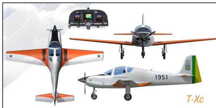
Representación del T-Xc, en la versión de entrenamiento primario. En el detalle se observa la cabina con una mezcla de instrumentación glass cockpit y análoga.
