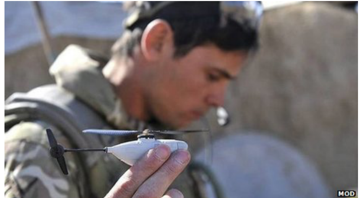
Foto: Drone Black Hornet desplegado en Afganistán por el Ejército británico. Son utilizados para descubrir puntos de insurgentes y comprobar zonas expuestas sobre el terreno antes de continuar la marcha. Fuente: www.bbc.co.uk
