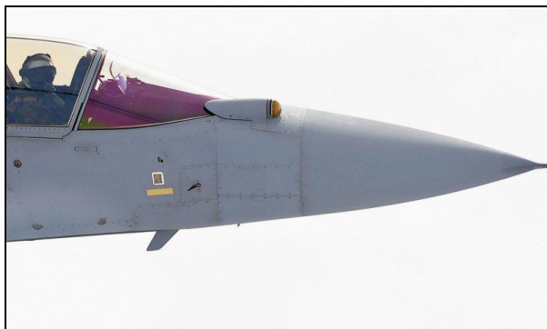
Foto: Acercamiento del sensor IRST Selex ES Skyward-G instalado en la parte delantera de la cabina del demostrador Gripen. Fuente: SAAB.
