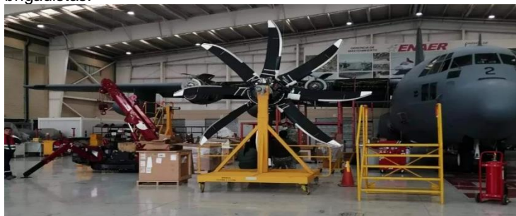
Trabajos de cambio de palas en ENAER del KC-130R Hércules N° 992.
