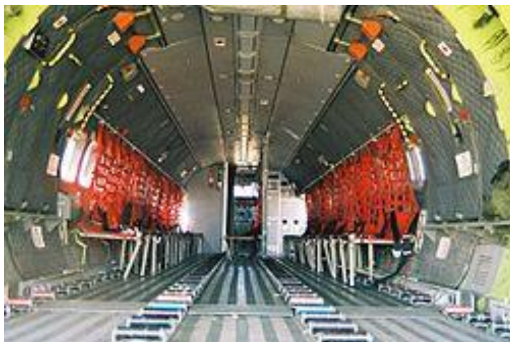
FOTO : Interior de un C-130. Nótese el sistema en el piso para un rápido movimiento de la carga y los asientos plegables
