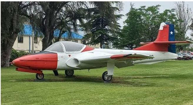
El XT-37 tenía un ala baja y recta, con los motores integrados a la raíz del ala, un diseño de control similar al de los aviones operativos contemporáneos de la USAF, asientos eyectables y tren de aterrizaje con un ancho de vía de 14 pies (4,3 m). Voló por primera vez el 12 de octubre de 1954.
