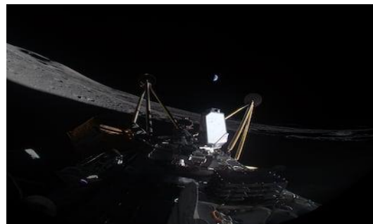
Imagen tomada por la sonda 'Athena', volcada dentro de un cráter lunar, con dos de sus patas apuntando hacia un cielo en el que puede verse la Tierra. INTUITIVE MACHINES.
