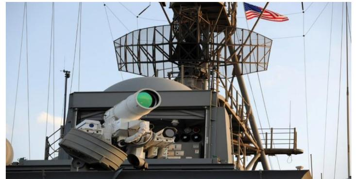
El sistema experimental High Energy Laser with Integrated Optical-dazzler and Surveillance (*HELIOS*) de Lockheed Martin, instalado en la cubierta del *USS Preble*. Fuente: [nationalinterest.org](http://nationalinterest.org), vía Reuters.
