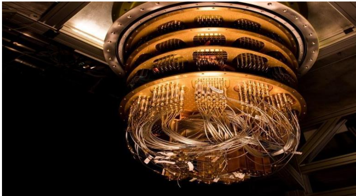
Computador cuántico Sycamore, de 53 Qubits, fabricado por Google en 2019, instalado en su laboratorio Goleta, en California. Fuente: Erik Lucero, vía Google.
