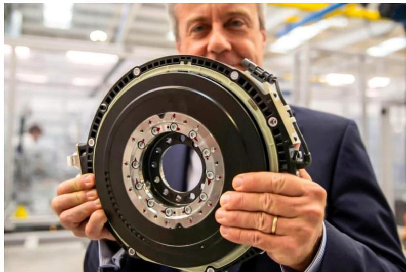
*Motor eléctrico de flujo axial. Fuente Testcoches.es*
