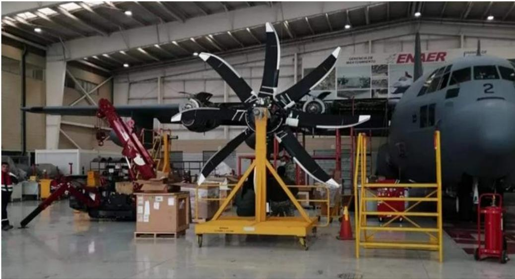
*Trabajos de cambio de palas en ENAER del KC-130R Hércules N° 992.*
