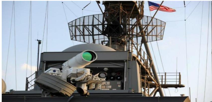
*El sistema experimental High Energy Laser with Integrated Optical-dazzler and Surveillance (HELIOS) de Lockheed Martin, instalado en la cubierta del USS Preble. Fuente: nationalinterest.org, vía Reuters.*
