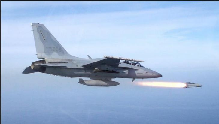
El FA-50 es un avión de combate ligero supersónico, pensado para reemplazar a los F-5 coreanos, en cuyo diseño inicial participó Lockheed Martin, por lo que muchos de sus componentes se asemejan a los del F-16, como la disposición de la cabina, su aviónica y su tren de aterrizaje. Está equipado con un motor turbofan F404-GE-102 como el que equipa a los Gripen y los F-18.
