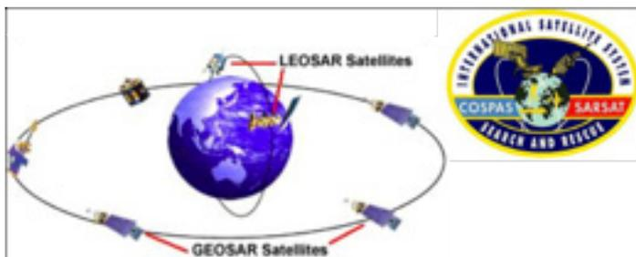
Figura 26: Ilustración de los sistemas LEOSAR Y GEOSAR, empleados por los sistemas de búsqueda y salvamento COSPAS-SARSAT. Fuente: SAR.
