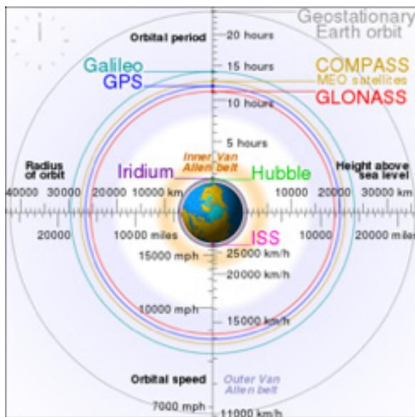
Figura 2: Representación gráfica de distintos tipos de órbitas, señalando algunas de sus elementos clásicos orbitales de radio, altitud, periodo y velocidad orbital, con ejemplos de varias misiones actualmente en operación. Fuente: Gmglee Geo Swan.
