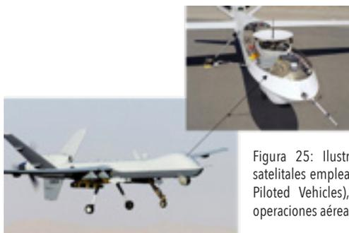
Figura 25: Ilustración de los sistemas de comunicaciones satelitales empleados a grandes distancias por los RPV (Remote Piloted Vehicles), haciéndolos esenciales para ese tipo de operaciones aéreas. Fuente: CEEA.
