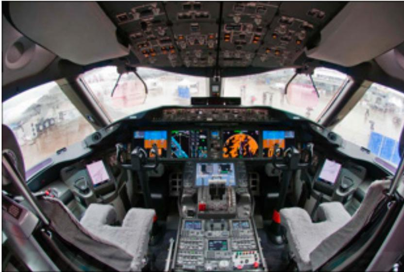
Foto: Cabina de Pilotos de la Aeronave B787 "Dreamliner" de Boeing. Considera pantallas del tipo Glass cockpit e incluso "Head-up display" para la información de vuelo. Mantiene la clásica columna de mando para el control de vuelo. Fuente: [www.google.com](http://www.google.com)
