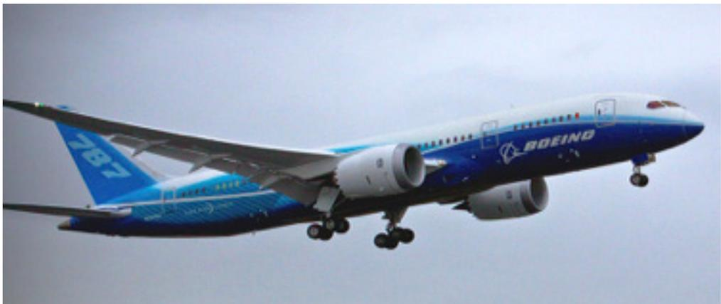
Foto: Aeronave Boeing 787 "Dreamliner", la cual ha incorporado en su fuselaje una importante cantidad de materiales compuestos, logrando reducir el peso total de la aeronave. Consume un 20 % menos de combustible que cualquier otro avión de su tamaño en misiones similares, haciéndolo más eficiente. Fuente: [www.google.com](http://www.google.com)
