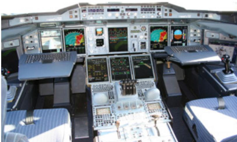
Foto: Cabina de Pilotos "Glass Cockpit" de una Aeronave Airbus 380. Se aprecia el alto nivel tecnológico con sus pantallas de información, teclados para computadores y joystick para el control de vuelo. Fuente: [www.google.com](http://www.google.com)
