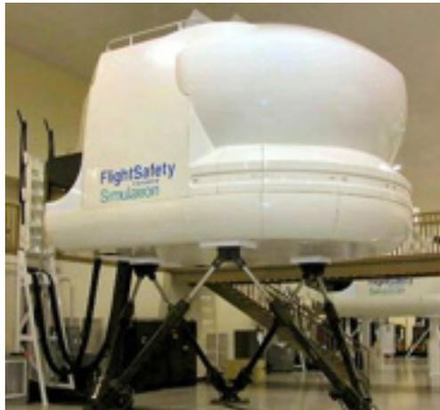
Foto: Vista exterior de un simulador de vuelo con movimiento de, al menos, tres ejes perteneciente a la empresa norteamericana Flight Safety. Fuente: [www.flightsafety.com](http://www.flightsafety.com)
