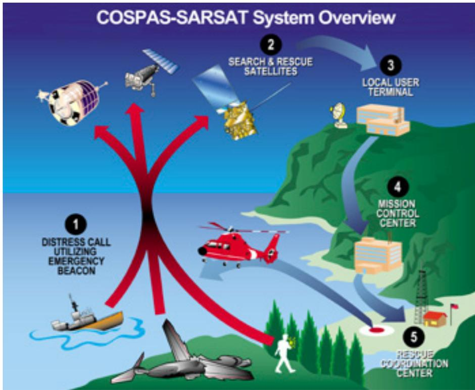
Figura 1: Vista general del funcionamiento del Sistema COSPAS-SARSAT.
