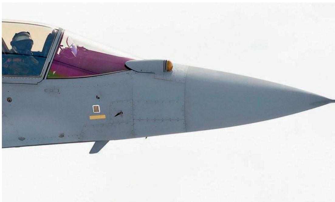
*Acercamiento del sensor IRST Selex ES Skyward-G instalado en la parte delantera de la cabina del demostrador Gripen. Fuente: SAAB.*
